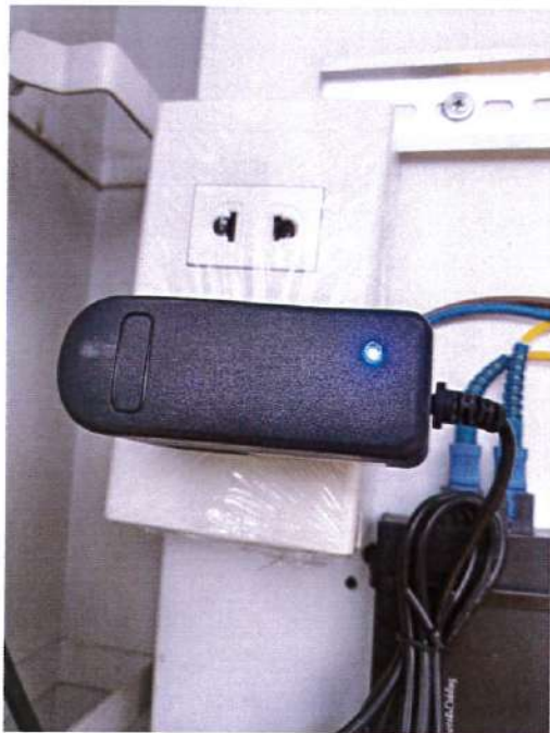
รูปภาพ Switching power supply ๑๒v ๒A และอุปกรณ์ต่อพ่วงภายในตู้เก็บอุปกรณ์
