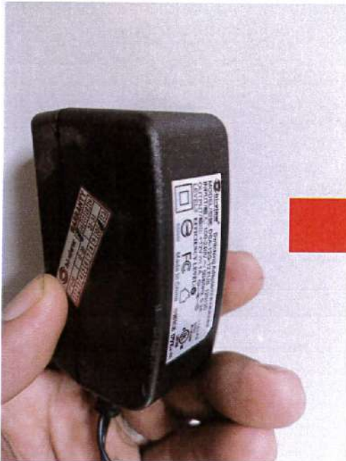
Switching Power Supply ตัวเดิม มี Output ๔.๘ VDC
