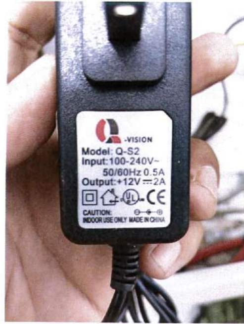
Switching power supply ๑๒v ๒A จำนวน ๑ ตัว
