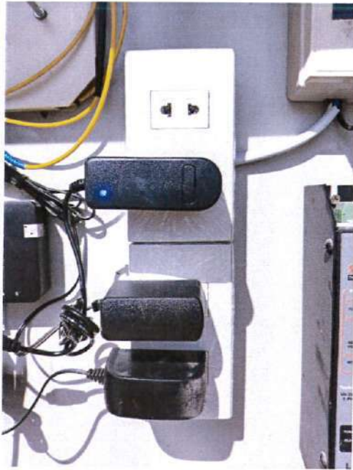
Switching power supply ๑๒v ๒A จำนวน ๑ ตัว
